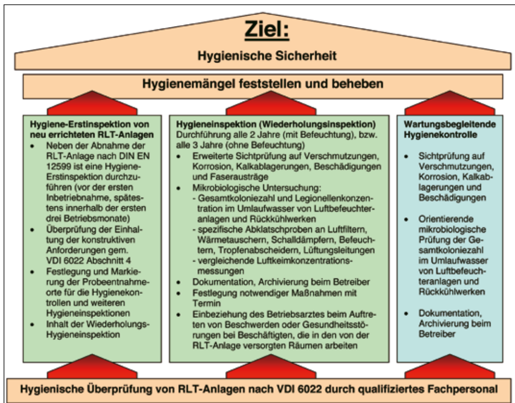
■ Bild 1: Maßnahmen zur hygienischen Überprüfung von RLT-Anlagen nach VDI 6022.
